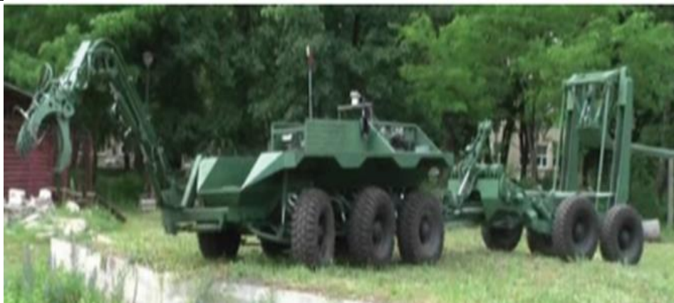
Рисунок 3. – Беспилотное наземное транспортное средство, для перевозки крупногабаритных грузов [4]
