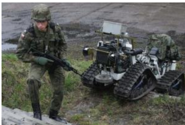
Рисунок 2. – Беспилотное наземное транспортное средство для поддержки пехотного подразделения [4]
