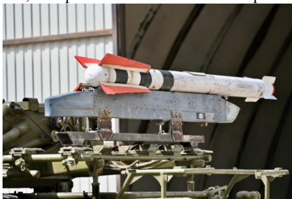
Рисунок 2. – Переходная балка для подключения АПУ с АУР Р-60М
