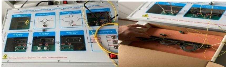
3-сурет. – Брэгг торлары негізінде талшықты-оптикалық сенсорларды зерттеуге арналған эксперименттік қондырғы
